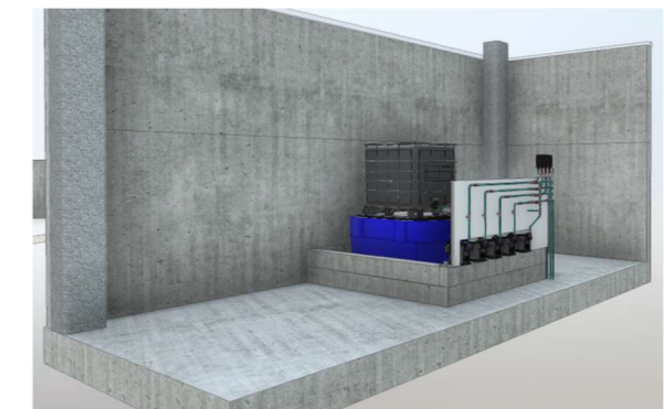
Figura 9. Estat projectat dispersant a 2n pas osmosi
