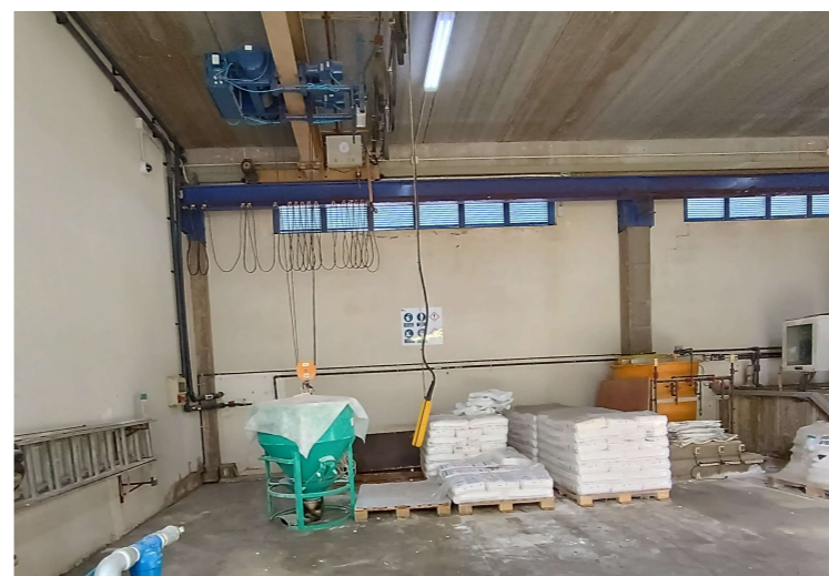
Fotografia 6. Pont grua per a manipular els sacs de 500 kg.
