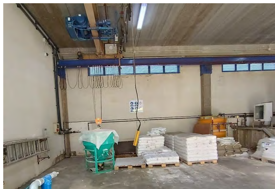
Fotografia 5. Pont grua per a manipular els sacs de 500 kg de metabisulfít sòdic..
