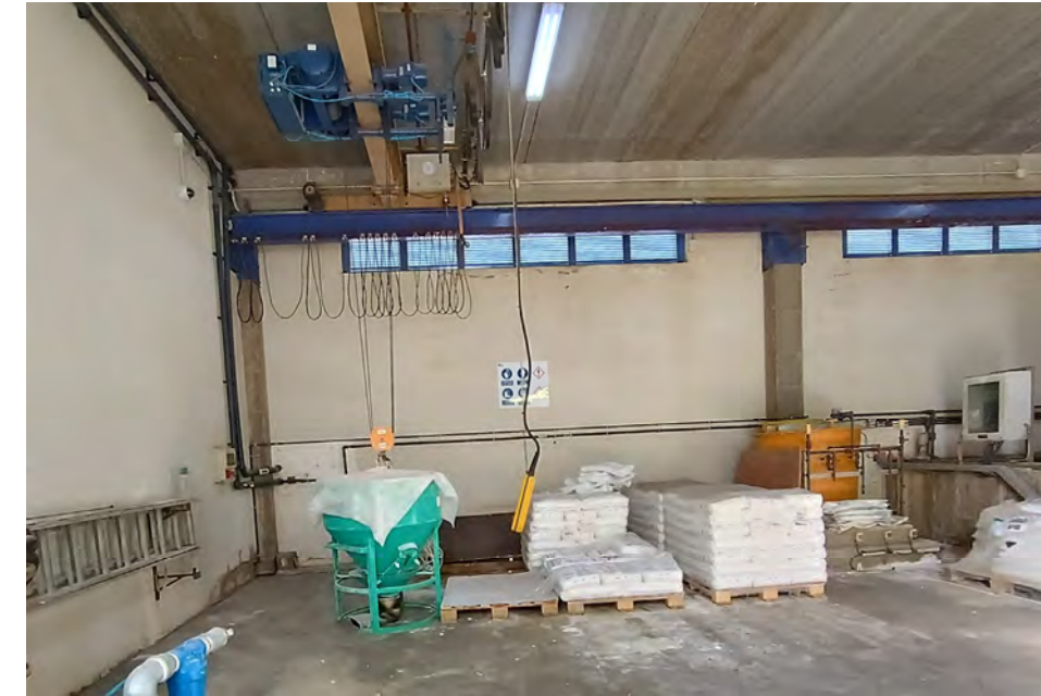
Fotografia 6. Pont grua per a manipular els sacs de 500 kg.
