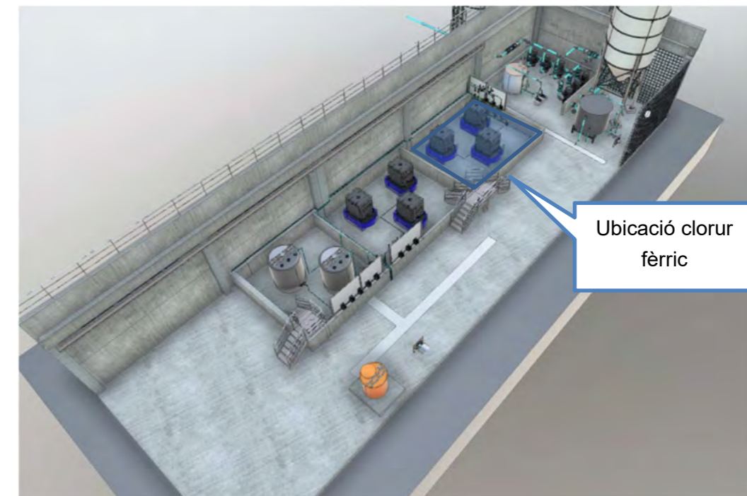
Figura 8. Ubicació actual i futura de la dosificació de clorur fèrric.
