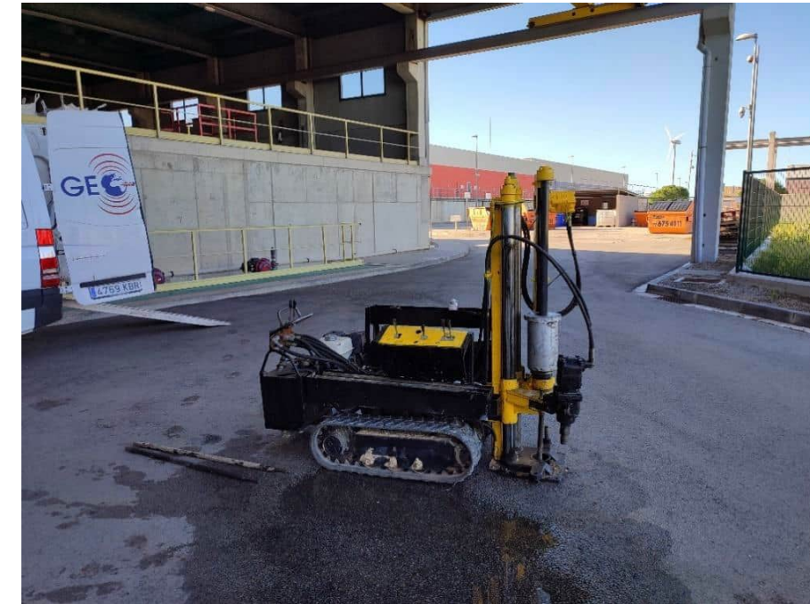
Figura 1. Sonda penetromètrica a l'emplaçament del P-2.
