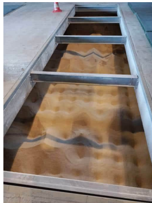
Foto 2. Llit ple de calcita, on s'observen les irregularitats en superfície del producte degut al pas de la calcita a través dels cons dosificadors inferiors.
