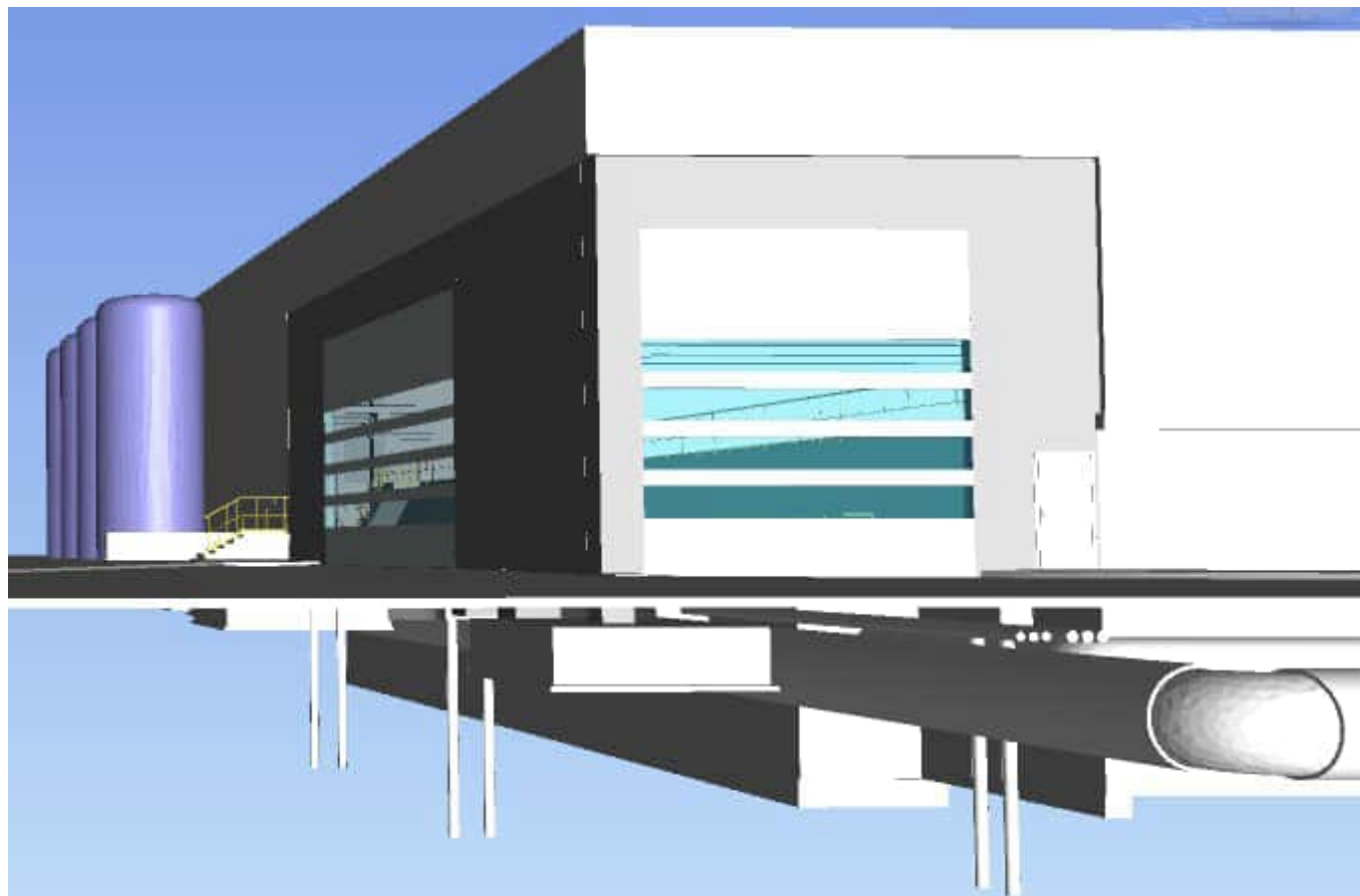
Figura 27. Exterior de la nau, façanes Nord (a l'esquerra) i Oest (primer pla), amb el detall sota paviment de les conduccions existents i la fonamentació projectada
